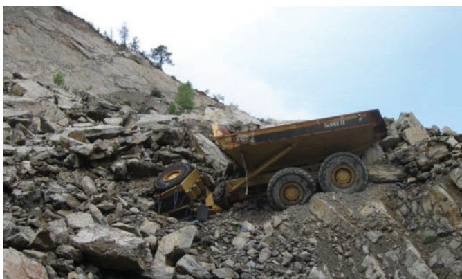
Effondrement d'un front de taille sur un tombereau
