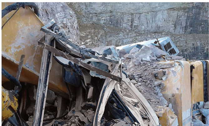
Effondrement d'un éperon rocheux sur une pelle
